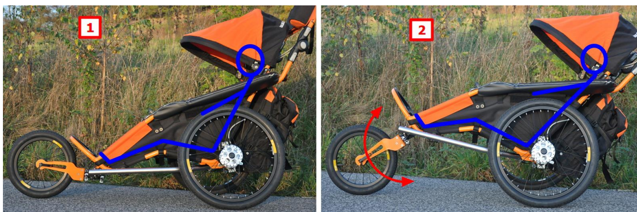
Abbildung 19 – die Neigung des Wagensitzes: 1 – Position Sitz; 2 – Position Lage
