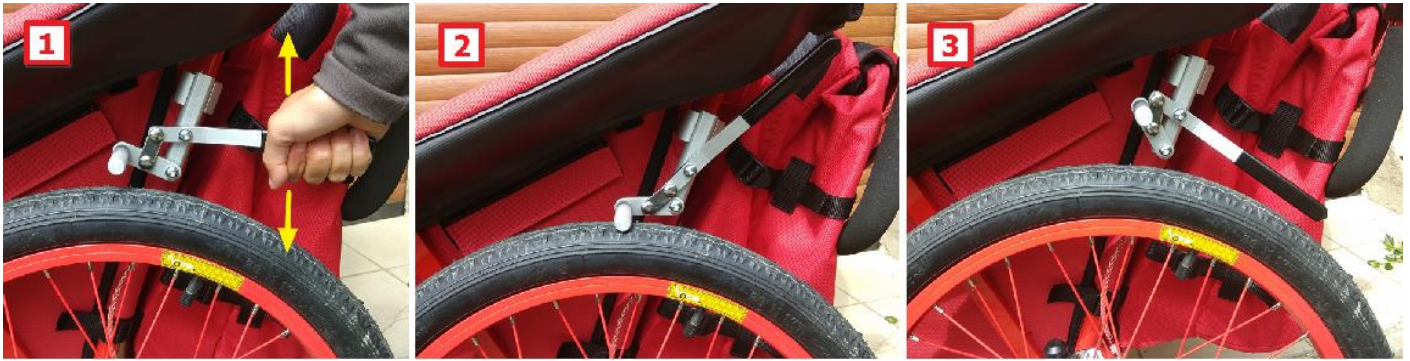
Abbildung 28 1 – Ergreifung der zusätzlichen Parkbremse 2 – Bremse vollständig arretiert 3 – Bremse geöffnet
