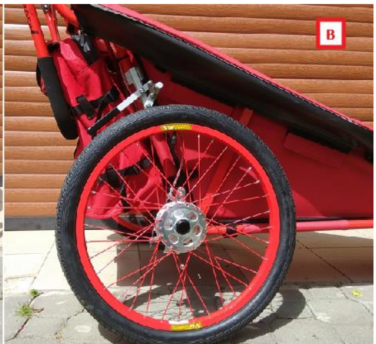
B – Zusatzparkbremse RECHTS
