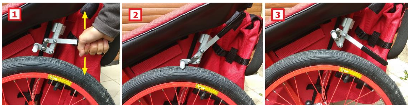
Obrázek 28 1 – uchopení přídavné parkovací brzdy 2 – brzda plně aretována 3 – brzda otevřená
