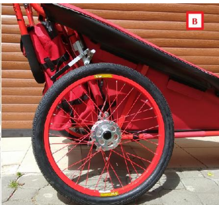
B – přídatná parkovací brzda PRAVÁ
