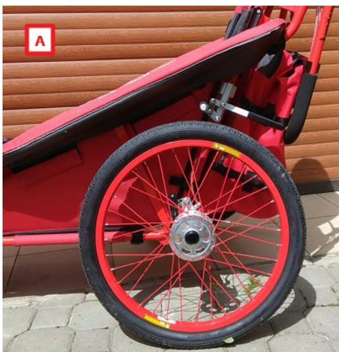
Obrázek 27 A – přídatná parkovací brzda LEVÁ
