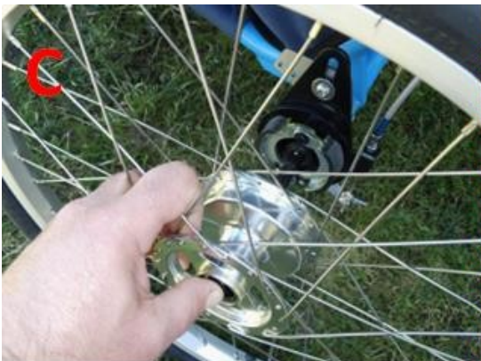
Abbildung 5 C Die Achse ist vollständig bis zum Anschlag einzuschieben.
