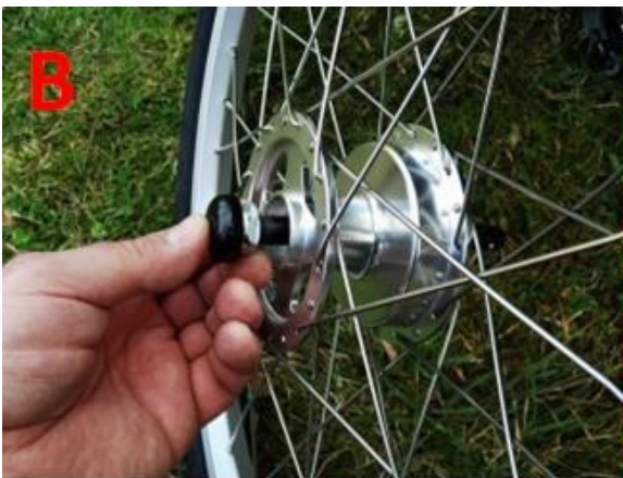
Abbildung 4 B – Die Schnellspannachse wird in die Aufnahme der Hinterachse eingesetzt.
