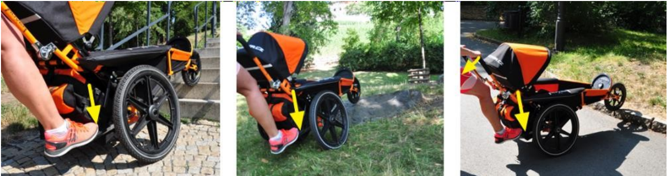
Abbildung 32 – Verwendung des Hebels beim Anheben der Vorderachse
