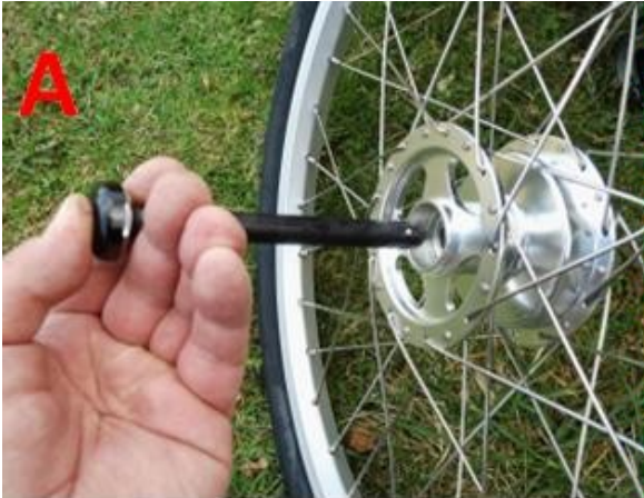
Abbildung 3 A – Durch Betätigung des Druckknopfes wird die Verriegelung gelöst.
